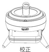
确认下机放置在坚硬且平稳之桌面上, 使用配件100g校正砝码, 将砝码放置于下机豆槽中央的圆柱平面上, 依屏幕指示进行操作, 即可自动完成电子秤重量校正。
